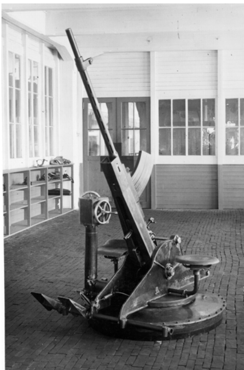
Konetykki kiinteisiin asennuksiin soveltuvalla kääntölaakerilavetilla
